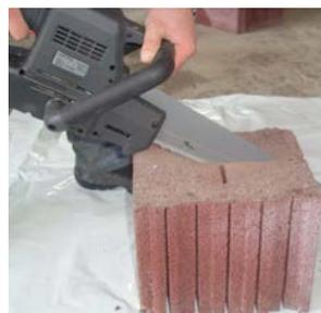
Liapor-PLAN-Steine können mühelos mit einer Steinkreissäge, Steinbandsäge oder auch mit einer elektrischen Schwertsäge geteilt werden.
